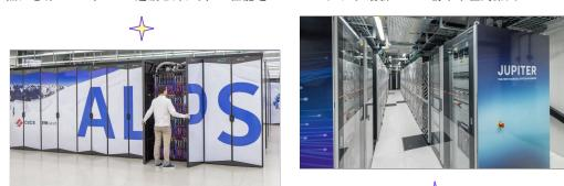
♦JUPITER超级计算机：位于德国于利希超算中心，基于Eviden的BullSequana XH3000直接液冷架构，采用Grace Hopper超级芯片，HPL性能达到1EFlop/s，是欧洲首台E级超算系统，在最新TOP500榜单上位列第四。
